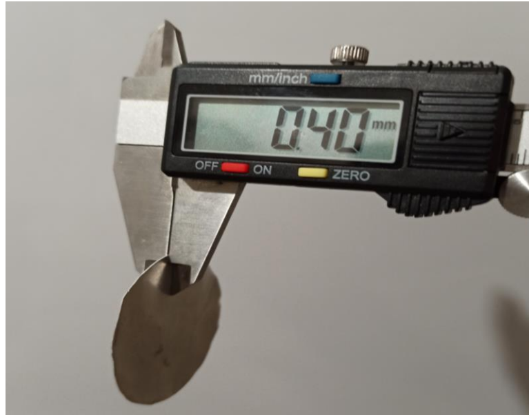
Рисунок 3 – Вимірювання товщини алюмінієвого листа (сплав 3105-H14)
